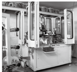
小規模企業者等設備導入資金制度を利用して導入した歯間ブラシ製造機
